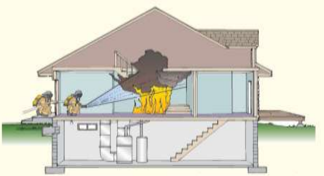
مكافحة حرائق المباني بطريقة غير مباشرة بضغط المياه الى مكان السقف المحترق وبالتالي تبريد الابخرة والغازات وارتداد المياه الى مصدر الحريق
