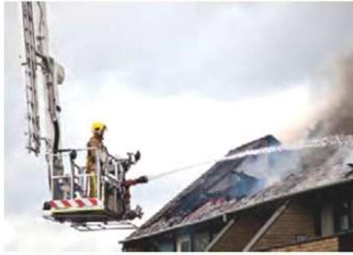
Elevated master stream devices can be mounted on aerial apparatus مكافحة حرائق المباني عن طريق عربة السلم الدوار
