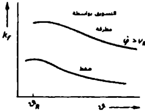
الشكل 388c) تأثير درجة الحرارة وسرعة التشكيل على k_f
