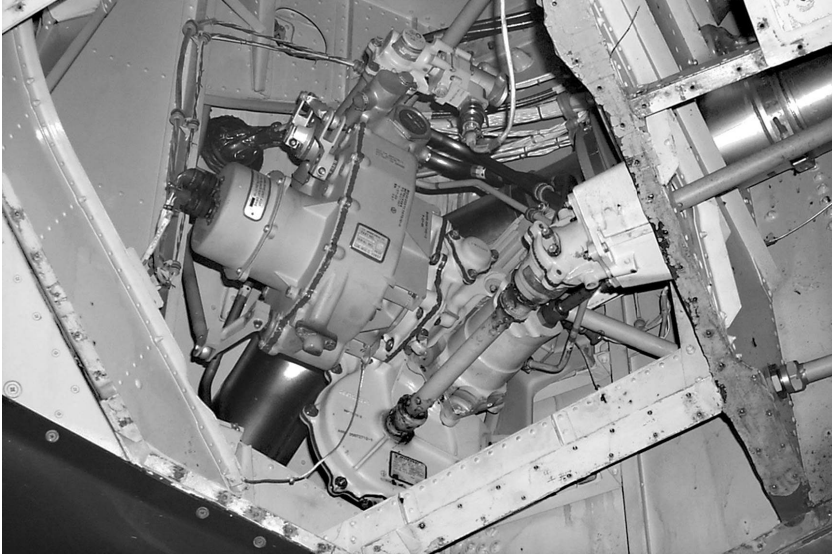
الشكل 1-4: محرك سوق القلاب للطائرة بوينغ 767 وما يرتبط به من آلية مرافقة.
