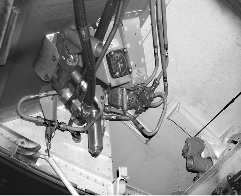
الشكل 1-2: نقطة شحن الخزان الهيدروليكي لبوينغ 767، يظهر حجم المحتويات وصمام التحويل ومؤشر مضخة هيدروليكية.
