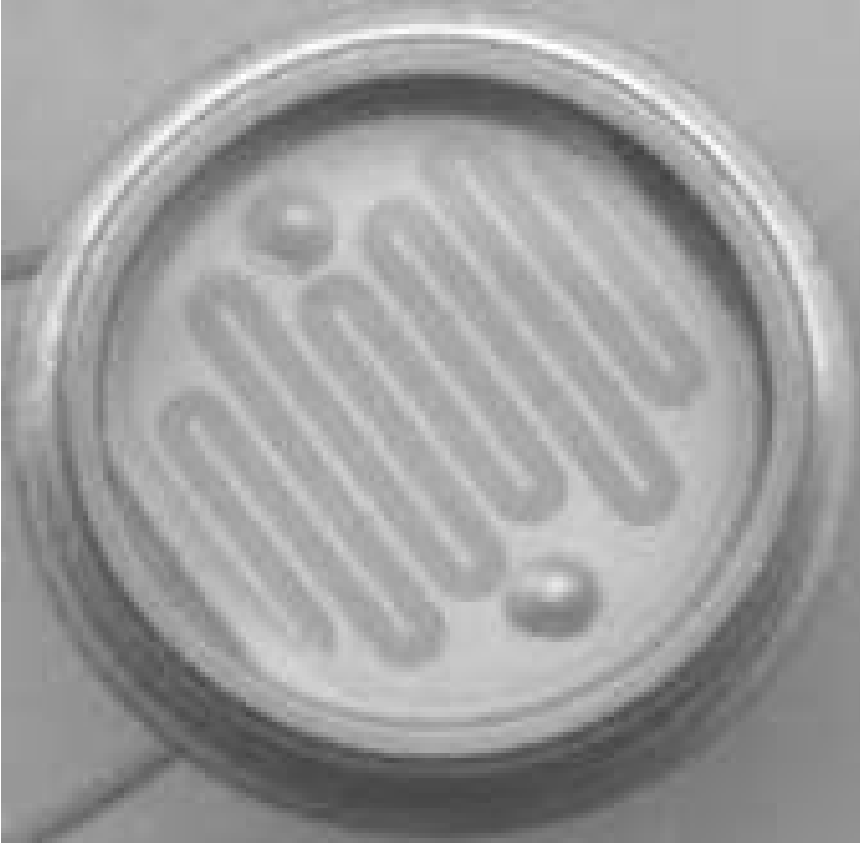
الشكل 5-11: مقاومة ضوئية-ناقلة (ذات الناقلية المتغيرة بالضوء) (LDR).
