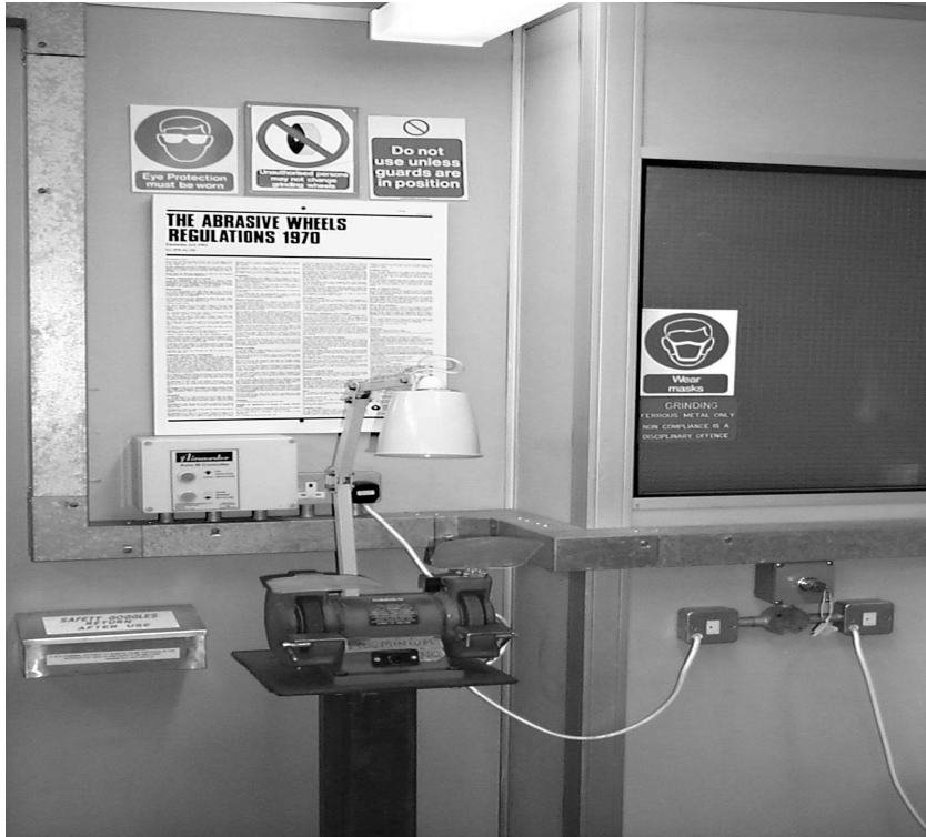
الشكل 1-19: آلة دواليب الشحذ (grinding wheel) مع إضاءة ملحقة وإشارات تحذير.
