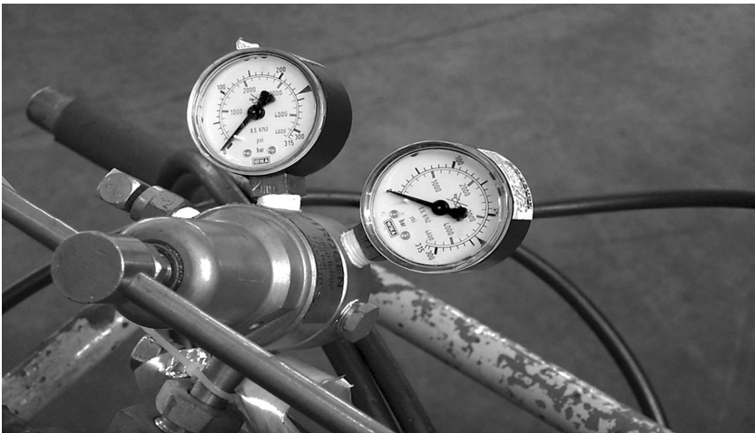
الشكل 1-23: مقياس الضغط مدرج بالـ bar وpsi.
