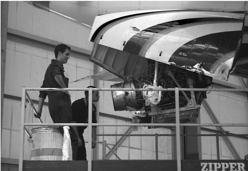
الشكل 1-5: الفنيون العاملون في أعلى سقالة لتأكيد استقامة وحدة الطاقة المساعدة APU وإجازتها ومن ثم تركيبها داخل الطائرة.
