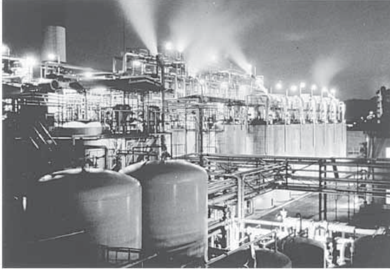
الشكل 10.14 مصنع Hakko Kyowa لإنتاج حمض أميني في اليابان تظهر 7 مخمرات كبيرة على اليمين كل واحدة بحجم 240 \text{ m}^3 ، وهي مناسبة لإنتاج L-glutamate.
