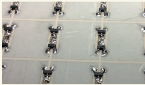
الشكل 1 | ماص لأشعة الميكروويف على سطح خارق. أ. تركيب السطح الخارق المتكرر، الذي صممه واكتسوشى وزملاؤه 1 . تحتوي كل خلية على رقعة نحاسية وأربعة صمامات ثنائية ومقاومة ومكثف. ب. صورة للسطح الخارق تبين تكرر الخلايا. يبلغ حجم كل رقعة 17 مم x 17 مم، مع وجود فجوة بطول 1 مم بين الرقع. ج. تعتمد امتصاصية السطح الخارق على عرض النبضة الواردة: حيث يتم امتصاص النبضات القصيرة بكثافة ويضمحل امتصاص النبضات الطويلة (أ) و (ب) من المرجح (1)
