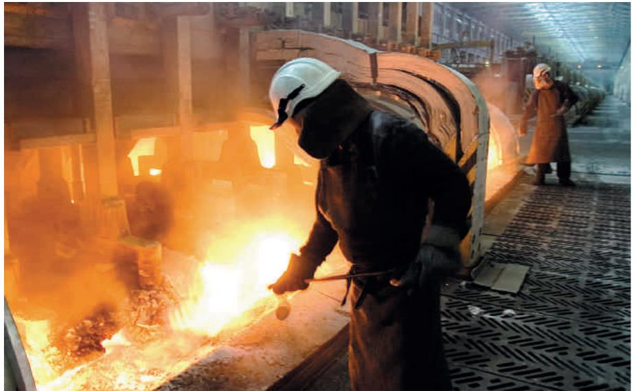
**الشكل 1 | استخلاص المعادن بالتحليل الكهربائي.** صورة من داخل مصهر ألومنيوم توضح لنا الظروف القاسية التي يجب أن تتحملها مكونات الخلايا الكهربية. أورد الأنود وزملاؤه<sup>2</sup> مواد يمكن استخدامها كمصاعد (أقطاب موجبة) في إنتاج الحديد كهربائياً.
