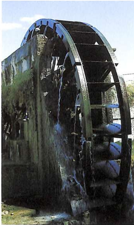
«ألكنتاريا» Alcantarilla (مُرْسِيَّة). ناعورة التَّيار العظيمة، من نفس شاكلة ناعورة «البولافيا» أو «أبو العافية» Albolafia بقرطبة.
